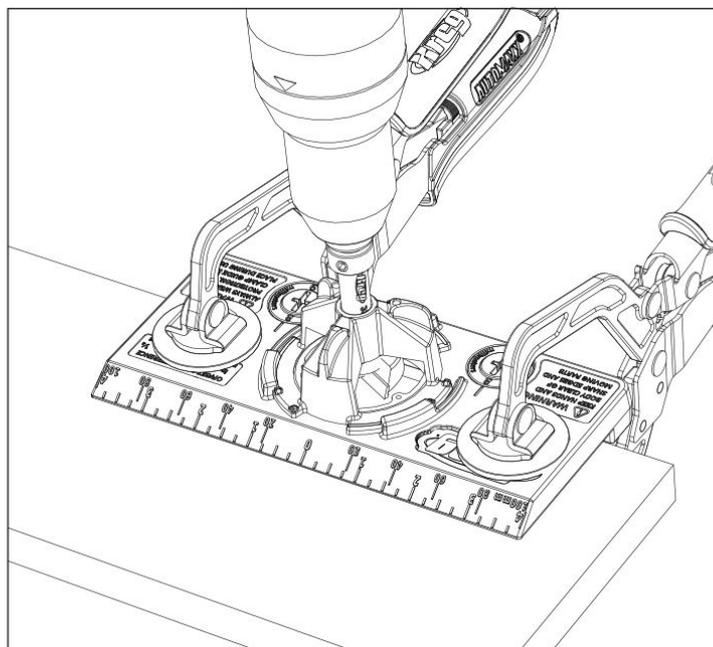
Coloque una  $\frac{1}{16}$ " (1,5 mm) broca en el taladro eléctrico. Inserte la broca en las guías de taladro de los tornillos de la bisagra en la base y taladre orificios guía en la puerta. Suelte las abrazaderas de la base y mueva esta hasta la siguiente ubicación de las bisagras.
